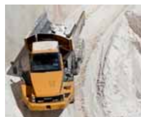
Более мелкие блоки мрамора вывозятся из карьера сочлененным самосвалом Cat 725.
