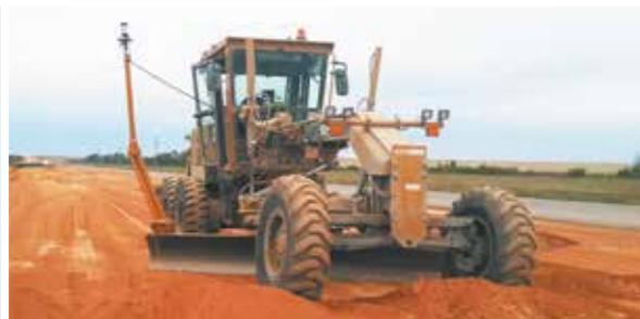
условия труда для работников с использованием качественной техники и внедряет перспективные технологии, в том числе системы Trimble. В геодезических работах используются специализированные инструменты, работающие от GNSS-спутников и позволяющие в реальном времени записывать отметки и работать с электронными проектами прямо в поле.
