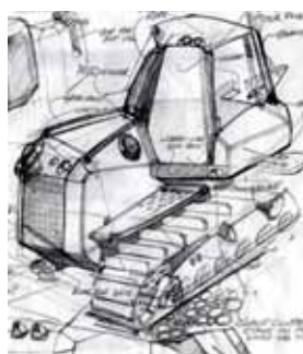
Предварительный эскиз D7E выдвигает на первый план новый подход к дизайну кабины, предлагая существенно улучшенную эргономику.
