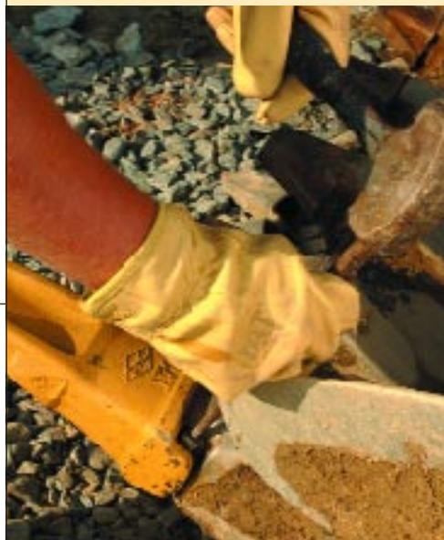
▲ Сквозной фиксатор легко снимается как с верхней, так и с нижней стороны наконечника. Чтобы отсоединить фиксатор, достаточно приложить небольшое усилие с помощью молотка и борodka.
