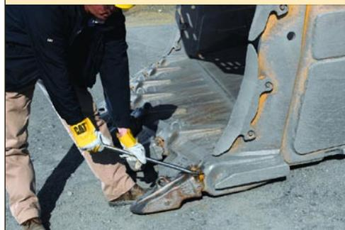
▲ Для отсоединения «замка» безударного фиксатора достаточно обычной монтировки.
