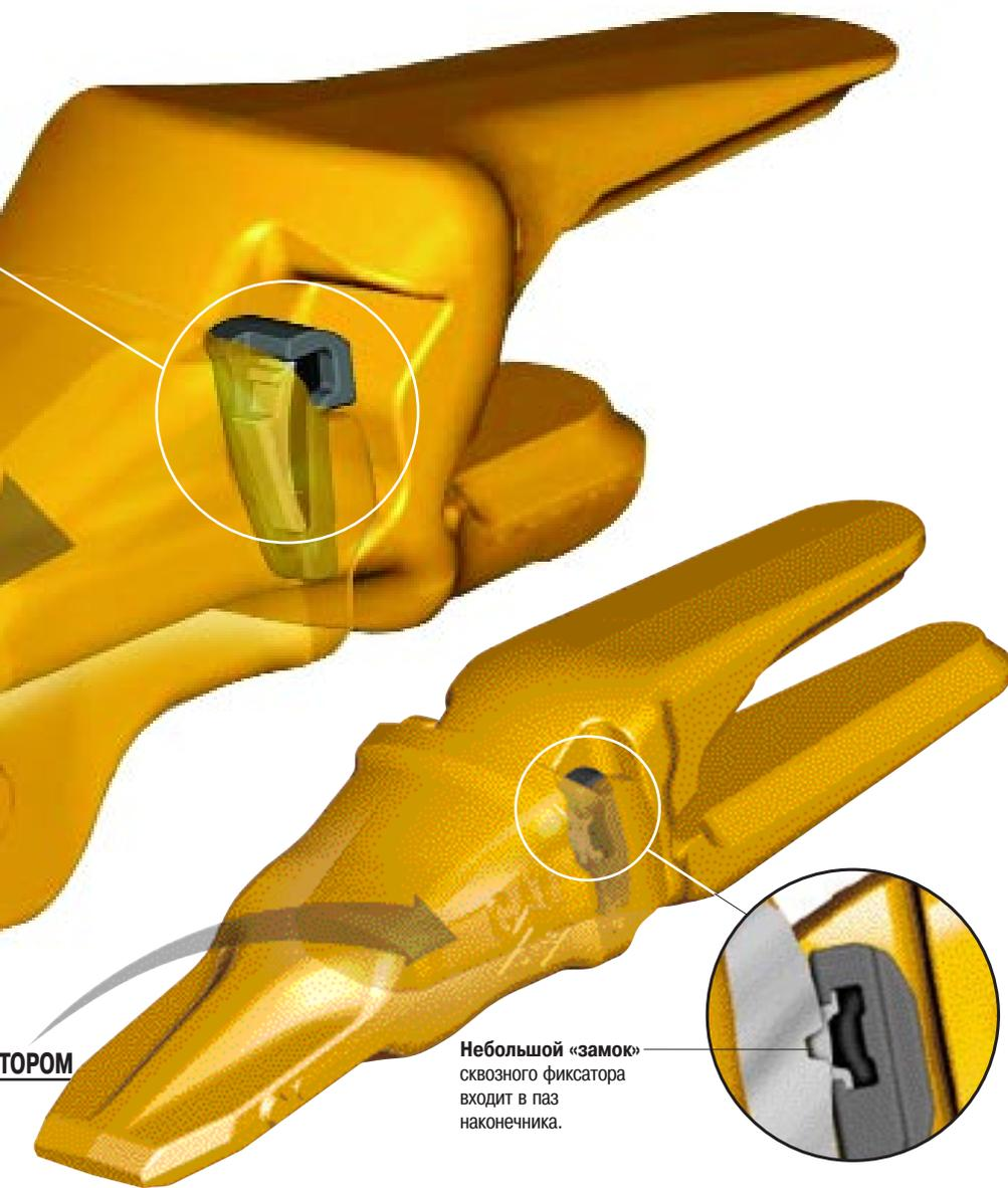
**Небольшой «замок»** сквозного фиксатора входит в паз наконечника.
