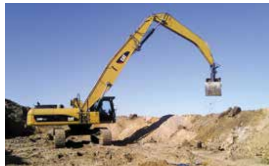
▲ Белорусская железная дорога. 330DMH разработка карьера песчано-гравийного материала.
